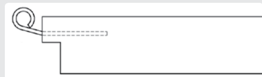
TGL Tür mit Fitschenband – Querschnitt
